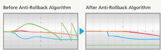
Green : Posion Error between Command & Actual Spd.
